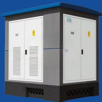
Os Postos de Transformação MT/BT EVA são projetados para operar em ambientes internos ou externos, com compartimentos de MT, transformador e BT. Podem ser fabricados em concreto monobloco, pré-fabricado, chapa metálica galvanizada ou alumínio, de acordo com as necessidades. Utilizam betão C35 em postos de concreto e aço galvanizado de 2 mm em postos metálicos.
